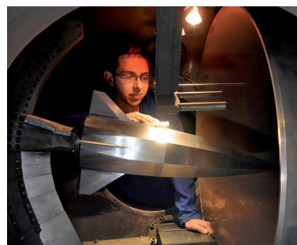
Untersuchung der Nutzlastspitze im Windkanal
